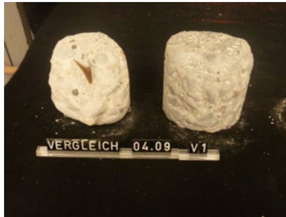
_Verschleißfesteste Vietnammischung V1 links nach 22h Prüfung mit Karlsruher rechts Vietnam Geschiebegut
