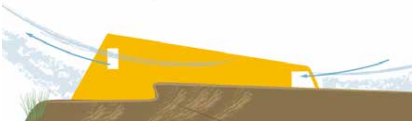
_Prinzip natürliche Querlüftung
