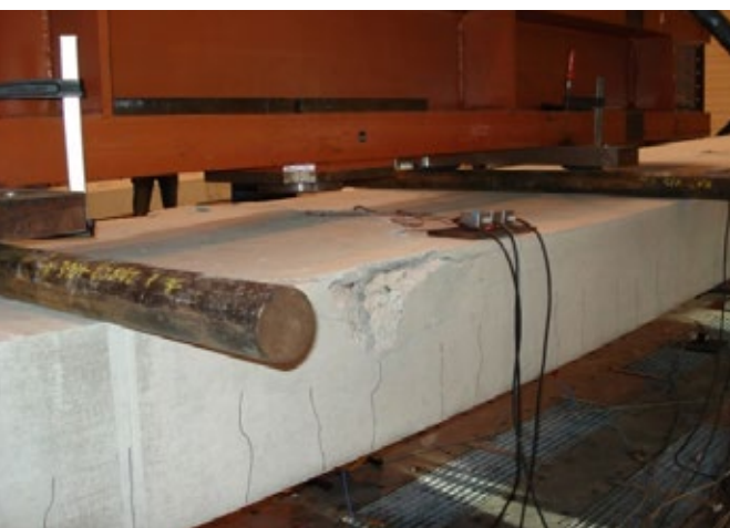
_Abb.6: Rissbilder der Versuchsträger nach Erreichen der Bruchlast
