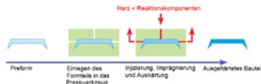
Abb.1: Schematischer Ablauf des RTM-Verfahrens (Eickenbusch und Krauss 2013)
