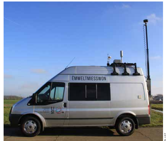
Abb. 1: Passivsammler mit Witterungsschutz (links), sowie Umweltmesswagen des Luxembourg Institute of Science and Technology (rechts).
