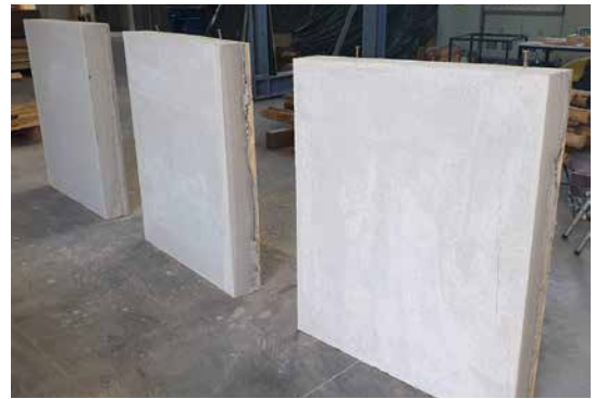
_Bild 8 - Hybridelement, Betonseite
