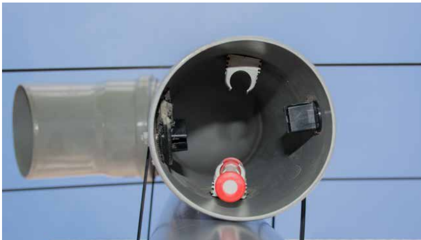
Abb. 1: Passivsammler mit Witterungsschutz (links), sowie Umweltmesswagen des Luxembourg Institute of Science and Technology (rechts).
