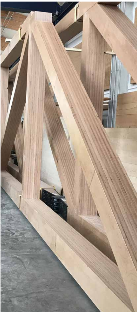
„Die BauBuche-Fachwerk-Hauptträger mit 3,80m Höhe werden abschnittsweise im Werk vormontiert.“
