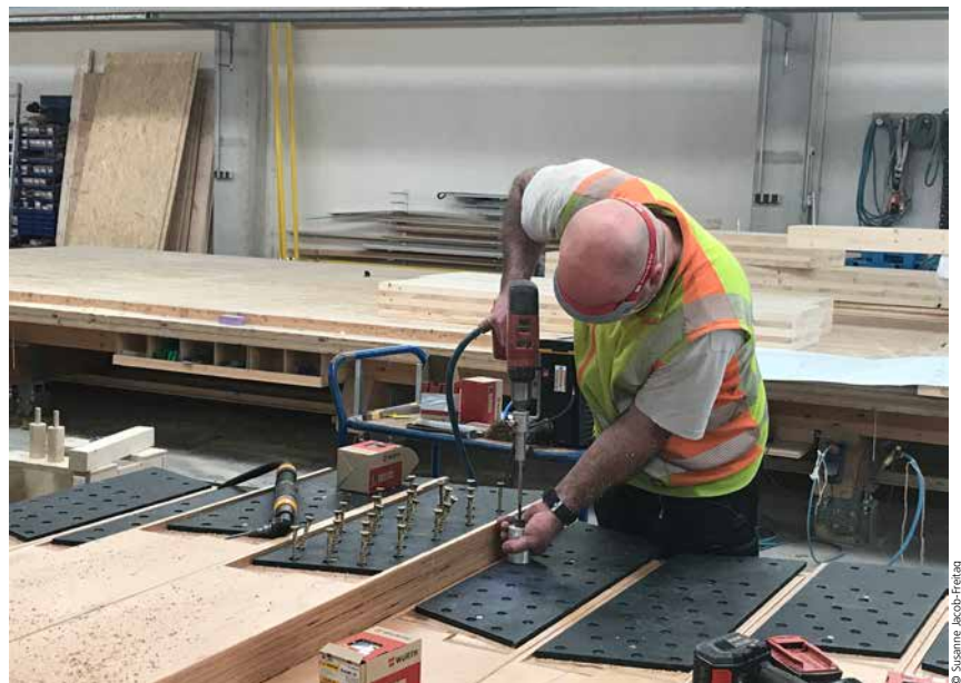
„Aufschrauben der Stahlbleche auf die „BauBuche“-Bauteile bei der Fertigung im Werk von Schlosser Holzbau“
