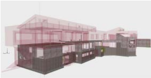
_Abb 14: digitales Gebäudemodell, Visualisierung und Darstellung der erhaltenswerte Betonelemente
