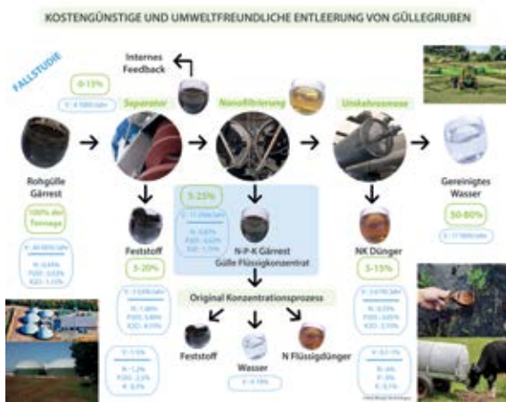
_Aufbereitung der Gülle mit Separation, Nanofiltration und Umkehrosmose
