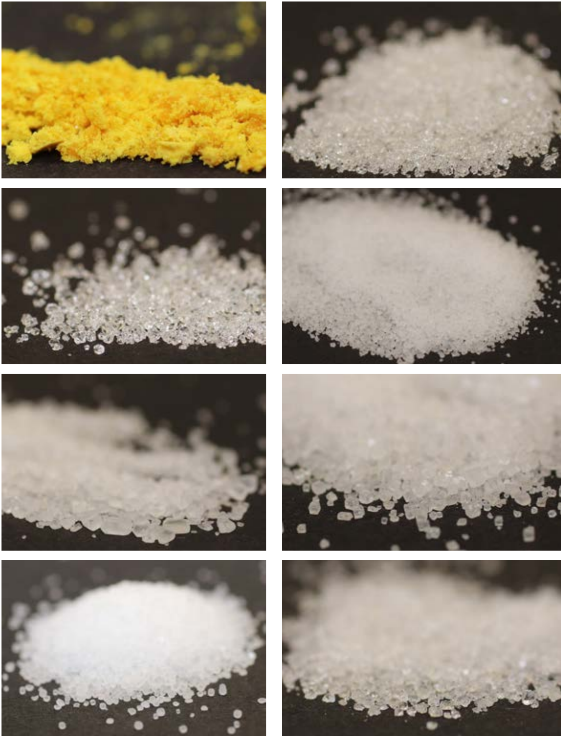
Abb. 2: Darstellung der anorganischen Salze für die Versuchsdurchführung. Von oben links beginnend nach unten, Eisen(III)-chlorid Hexahydrat ( \text{FeCl}_3 \cdot 6\text{H}_2\text{O} ), Kaliumdihydrogenphosphat ( \text{KH}_2\text{PO}_4 ), Magnesiumsulfat-Heptahydrat ( \text{MgSO}_4 \cdot 7\text{H}_2\text{O} ) und Natriumchlorid ( \text{NaCl} ). Rechte Seite von oben nach unten, Kaliumchlorid ( \text{KCl} ), Magnesiumchlorid-Hexahydrat ( \text{MgCl}_2 \cdot 6\text{H}_2\text{O} ), Natriumbromid ( \text{NaBr} ) und Natriumdihydrogenphosphat ( \text{NaH}_2\text{PO}_4 ).
