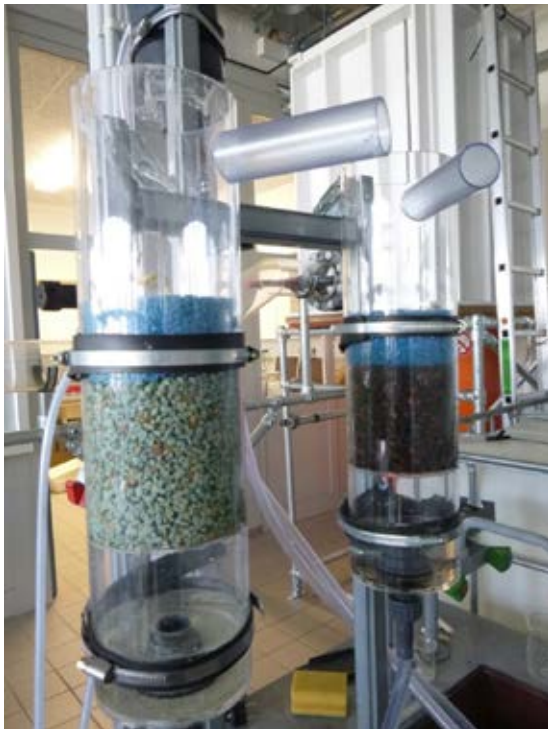
_Abb. 1: Filtersäulen zur Untersuchung der Schwermetallreduktion
