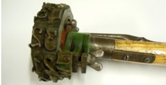
— Ancien marteau-marqueur utilisé par la famille Waxweiler du moulin de Beckerich pour marquer les arbres à abattre
