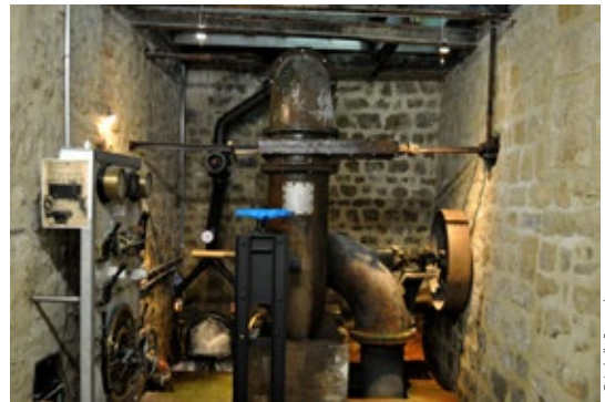
— Le «cœur du Millemusée»: l'ancienne turbine qui faisait fonctionner le moulin, la scierie et qui produisait de l'électricité pour le village de Beckerich
