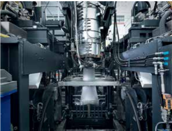
„Geberit Spültanks werden im Extrusionsblasverfahren hergestellt. Die heisse Blase aus zähflüssigem Polyethylen (Bildmitte) wird von dieser Maschine zu einem Spültank geformt.“
