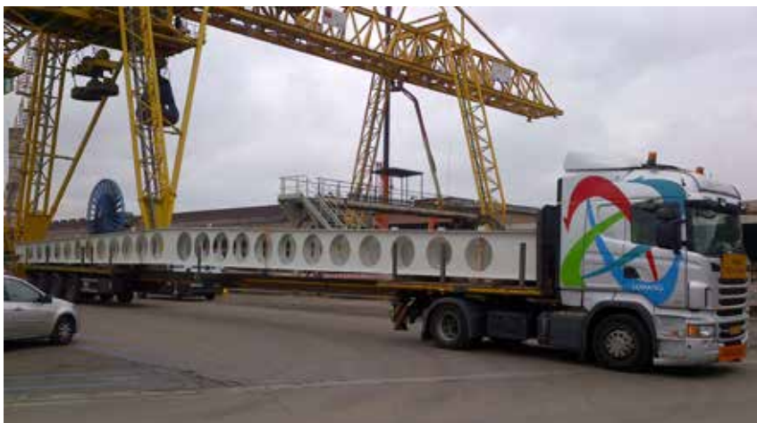
Transport von ACB®-Dachbindern zur Baustelle – Lieferlänge 29,80m
