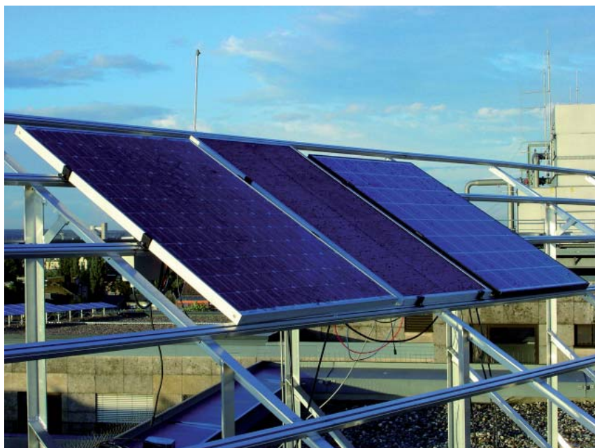
Expérimentation de panneaux photovoltaïques en conditions météorologiques réelles
