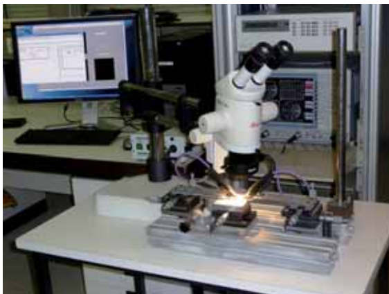
Charakterisierung eines Transistors auf Galliumnitrid-Basis mit einem 40 GHz S-Parameter Messplatz
