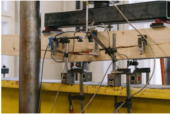
Abbildung 7 Totalversagen der Hybridträger
